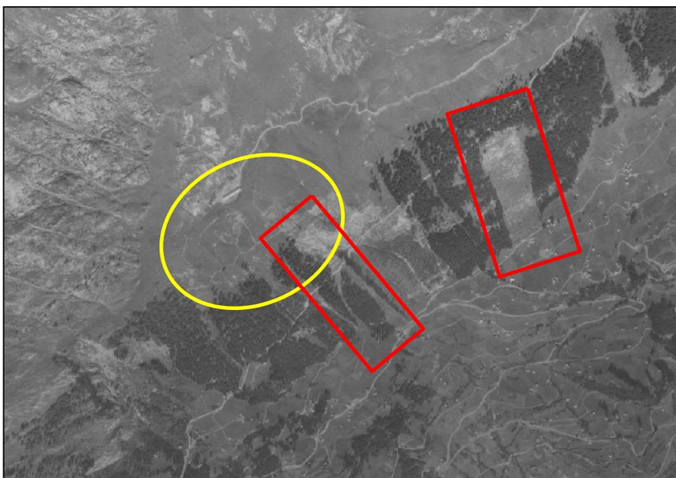
**Figure 9** : Mise en évidence sur l'orthophoto de 1969 des deux cicatrices laissées dans la forêt par les avalanches de 1966 (rouge). A noter la mise en place des premiers ouvrages de protection (jaune)
